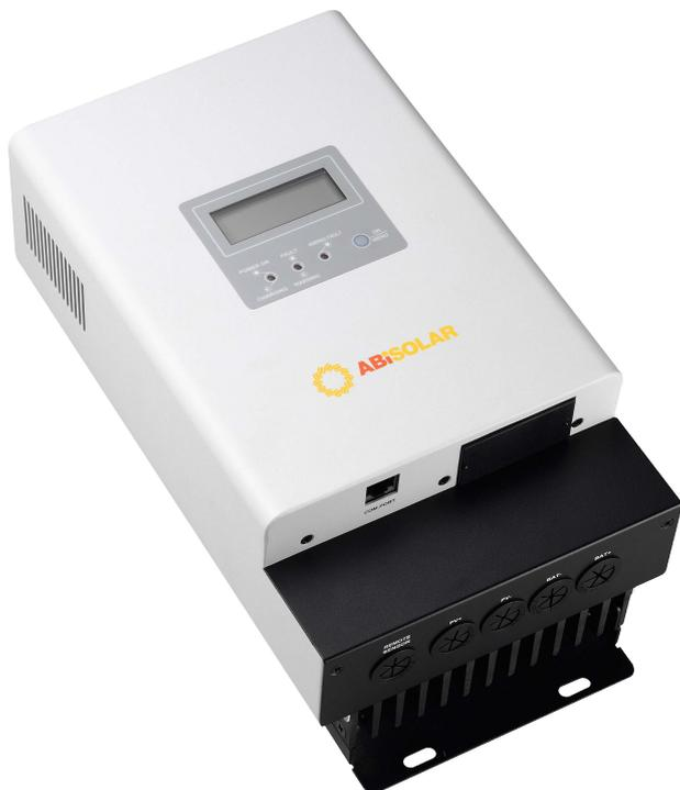
Солнечный MPPT контроллер заряда мощно-стью 3кВт. ABi-Solar MXC совместим с любыми типами фотомодулей и может заряжать как свинцово-кислотные так и никель-кадмиевые аккумуляторные батареи с номинальными напряжениями 12В, 24В и 48В.
